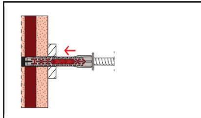
3. Einbringen des Dübels (Schraube und Dübelhülse) mit einem Hammer, bis der Rand der Dübelhülse bündig an der Oberfläche des zu befestigenden Teils anliegt.
