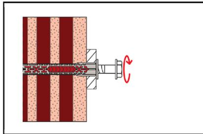
4. Die Schraube wird eingedreht bis der Schraubenkopf die Dübelhülse berührt. Der Dübel ist richtig verankert, wenn nach dem vollen Eindrehen der Schraube weder ein Drehen der Dübelhülse auftritt, noch ein leichtes Weiterdrehen der Schraube möglich ist.
