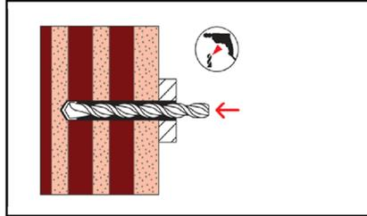
1. Bohrlocherstellung (Durchmesser) nach Tabelle B2.1 mit den Bohrverfahren nach Anhang C.
