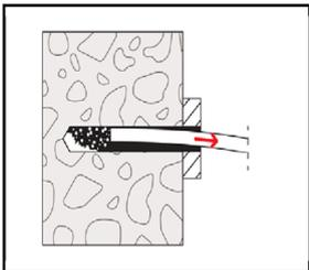
Bei Anwendung in Lochbaustoffen ist die Bohrmehlentfernung nicht notwendig.
