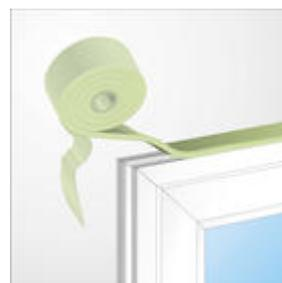
Bild 2: Komplette Abdichtung in einem Arbeitsschritt
