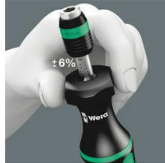
Von Hand verstellbar auf entsprechende Skalenwerte. Einfache Einstellung des benötigten Drehmomentwerts von Hand. Messgenauigkeit  $\pm 6\%$  nach Norm DIN EN ISO 6789. Deutlich hör- und spürbares Überrasen beim Erreichen des eingestellten Drehmoments.
