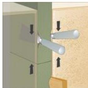
Bild 2: Stumpfstoß im Massivbau
