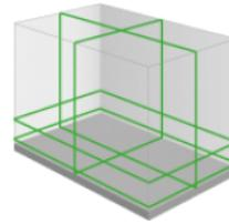
4D-Kreuzlinienlaser - Elektronische Nivellierung - Wird mit einer interaktiven Fernbedienung geliefert - Zweite horizontale Linie unter dem Gerät, 20 mm über dem Boden - Genauigkeit 1 mm/10 m - Reichweite 2x 60 m - Lithium-Ionen-Akku.
