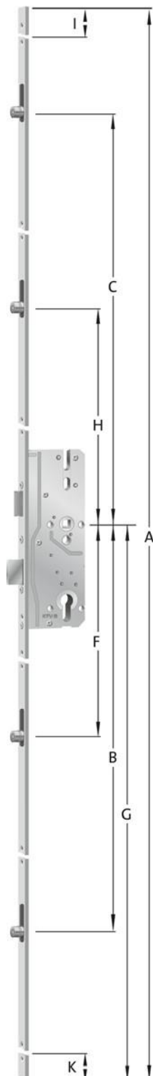
Roll- oder Pilzzapfen (Maße immer in verriegelter Position angeben!)
