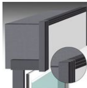
Bild 3: Band senkrecht auf die Kopfstücke kleben
