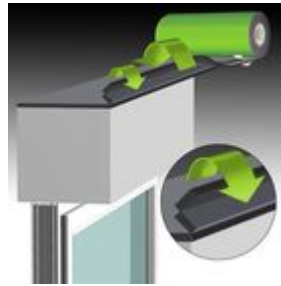
Bild 1: Band zweimal umklappen und innen bündig auf den Kasten kleben
