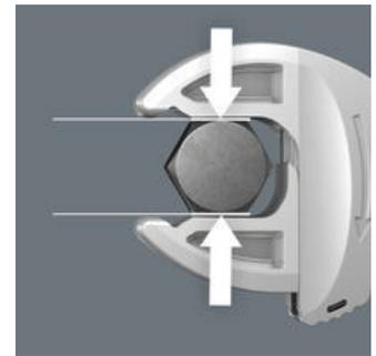
Die parallelen glatten Backen des 7880 Joker ermöglichen eine Flächenpressung und können dadurch das Verrunden der Mutter bzw. des Schraubenkopfes vermeiden, was bei der Kraftübertragung über Ecken auftreten kann.
