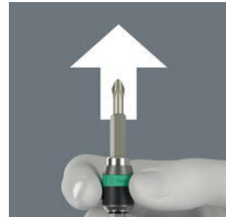
Zum Bitwechsel einfach die Hülse nach vorne schieben: Dabei hebt der Federmechanismus den Bit vom Magneten ab und entriegelt das Werkzeug. Der Bit kann problemlos entnommen werden. Besonders hilfreich: Mühllose Entrahme auch kleinsten Bitgrößen ohne Hilfswerkzeug.
