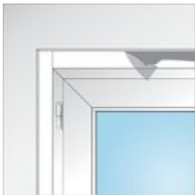
Bild 4: Die Leisten werden stumpf gestoßen.
