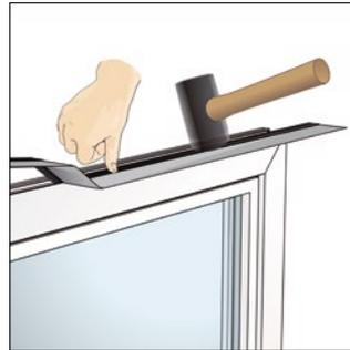
Bild 6: Geeignete Kederfolie in die äußeren Blendrahmen-Nuten einbringen
