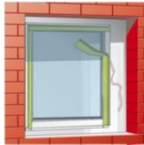
Bild 1: TP601 mit der Selbstklebung am Fensterrahmen fixieren.
