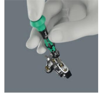
Die Bits haben einen 4 mm Sechskant Antrieb. Die im Tool-Check Modular Micro 1 enthaltenen Größen sind besonders für feinmechanische Arbeiten geeignet.
