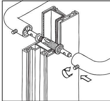
5. Griffe von beiden Seiten aufstecken. Gewindestifte mit Sechskantschlüssel SW 3 festdrehen.
