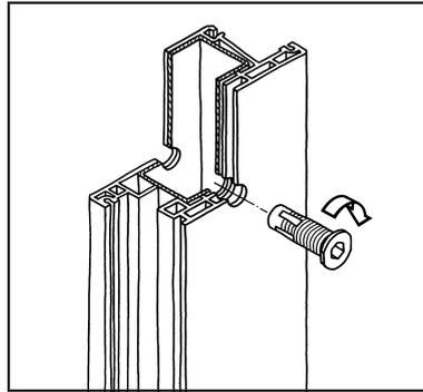
2. Montagehülse bündig mit langem Sechskantschlüssel (SW 10) eindrehen.
