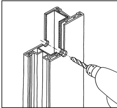
**1.** Bohrung für Montagehülse 14 mm  $\varnothing$  bohren.
