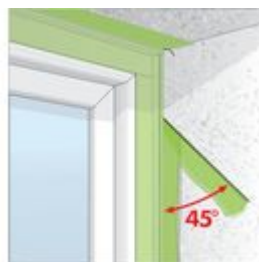
Bild3: Überstehende Folie mit dem Reißfaden unter 45° abreißen.
